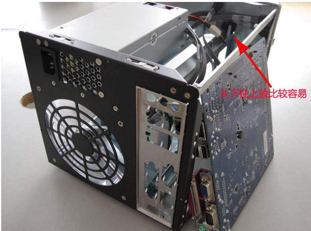
2、使用螺丝将绝缘塑料片、主板固定到主板
