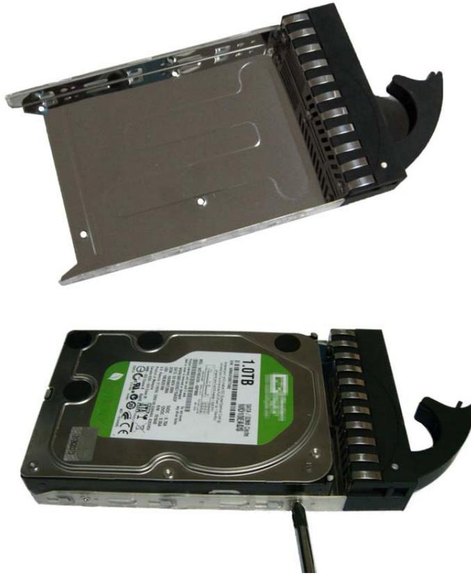
放入 NS-400 中，接上电源、网线开机，一切 OK，感谢您使用万由产品！
